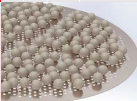
Dispositivo disintasante con vassoio forato inox e sfere in gomma FDA, da applicare sotto la rete del vibrovaglio
